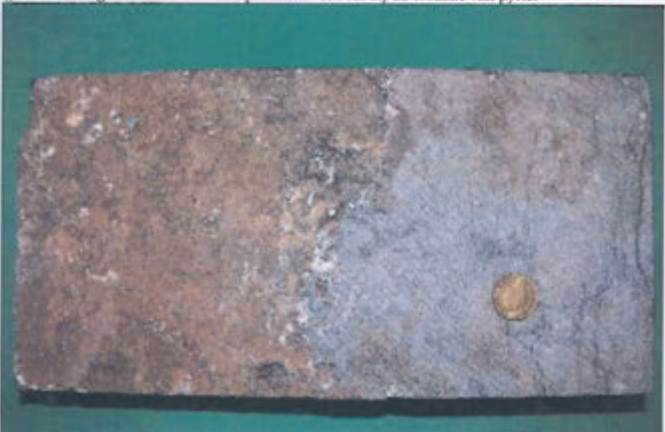
Bovenaanzicht van schuin aangesneden bruin verkleurde zone in verkleurde boordsteen, vervaardigd in Petit Granit (CO'PRO-staal)
