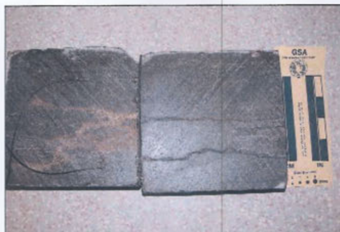
Doorgezaagde boordsteen. Bruine verkleuring van Chinese blauwe steen, langs weerszijden van vochtopnemende zwarte voegen (styloliet) (COPRO-staal)
